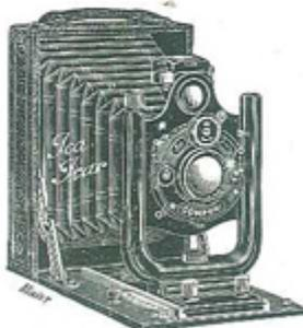
Appareil pliant de construction très soignée, étudié pour objectifs F. 4,5. Corps en fonte d'aluminium, gainé maroquin fin. Soufflet peau noire. Echelle graduée à toutes distances et arrêt automatique sur l'infini. Ferrures nickelées et émaillées noires. Obturateur "Compur" à secteurs. Déclencheur métallique. Diaphragmes à iris. Décentrement dans les deux sens. Grand viseur clair réversible avec niveau d'eau. Viseur Davanne. Deux écrous de pied
