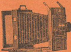
Chambre légère en noyer demi-vernî, très soigné, soufflet Karatol renforcé. Coins peau. Long tirage monté sur cône tournant, chariot à double crémaillère avec vis de serrage. Double bande d'accrochement anglaise. Double décentrement horizontal et vertical, cadre verre dépoli à charnières, équerres de renforcement. Ferrures et poignée cuivre avec 3 châssis doubles entièrement à rideaux.
